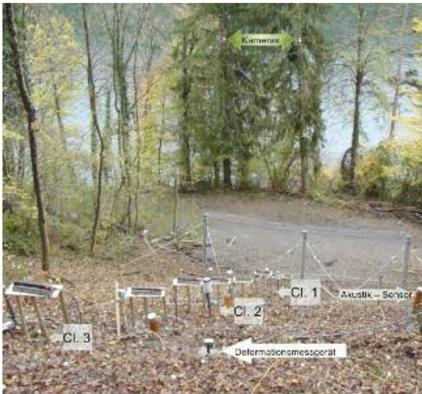
Abb. 4: Lage der Messinstrumente, der Berechnungsanlage und der Photogrammetrie-Kameras.
