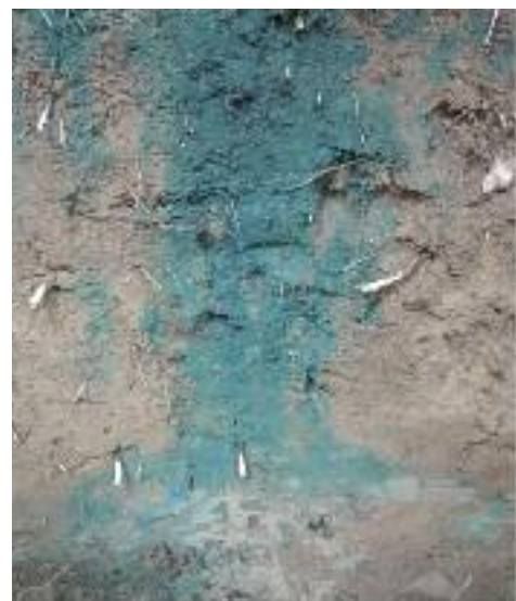
Abb. 3: Infiltrationsmuster in einem Bodenprofil (Massstab: Von der Bodenoberfläche bis in 1.3 m Tiefe).
